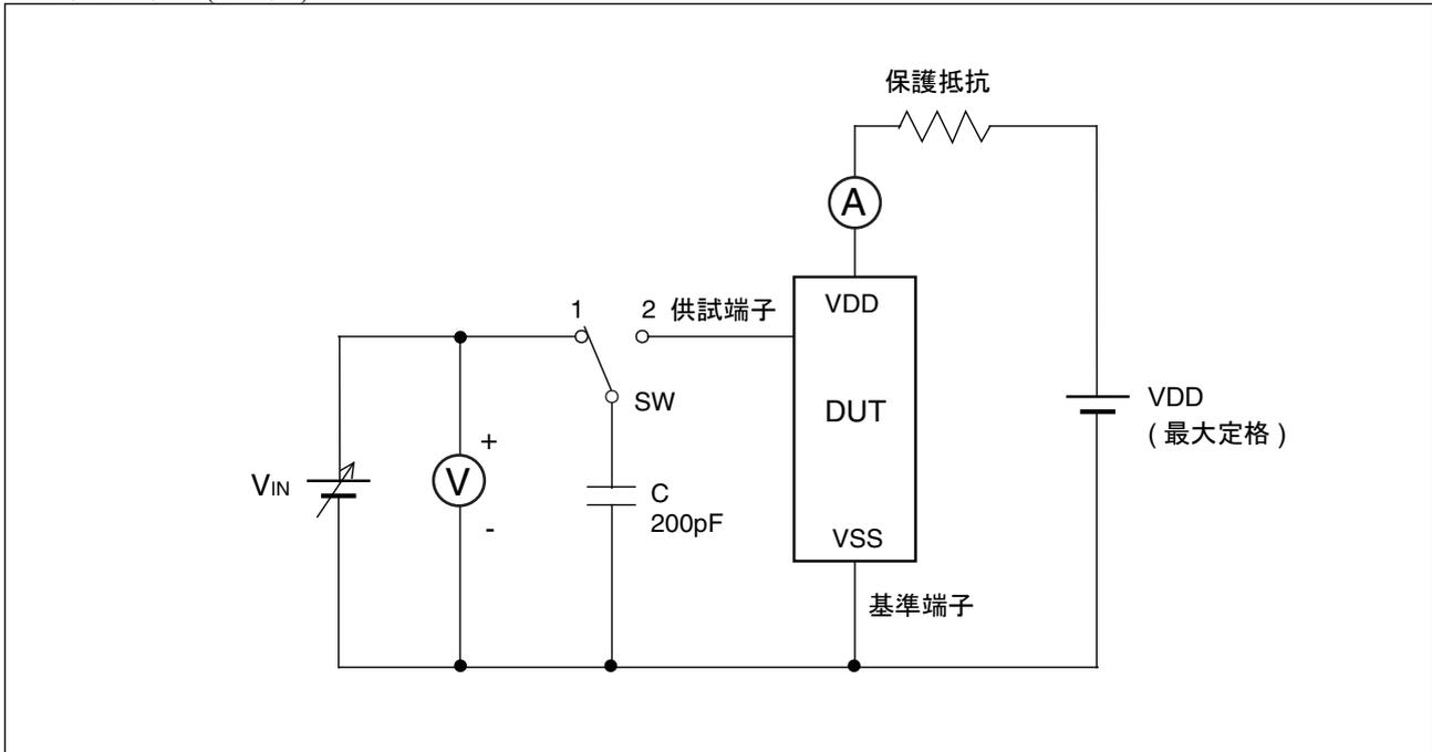
(注意事項) SW を約 2 秒間隔で 1 ～ 2 に交互に切り換え、電圧を印加します。
