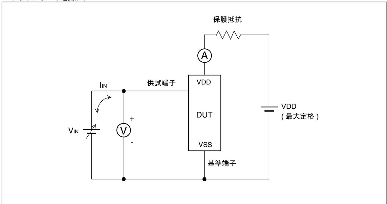
(注意事項)  $V_{IN}$  の電圧を徐々に増加させ、 $I_{IN}$  を最大 300 mA まで流し込みます(または流し出します)。
