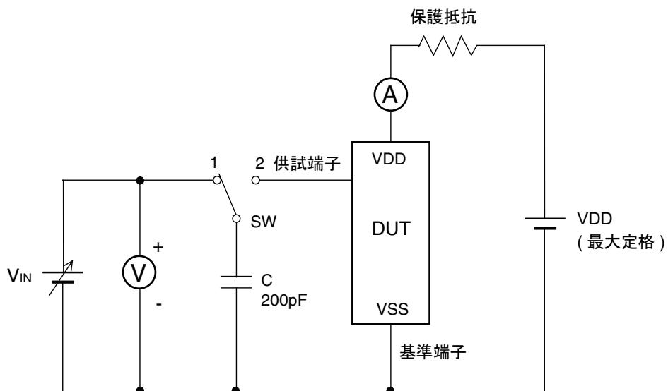
(注意事項) SW を約 2 秒間隔で 1 ~ 2 に交互に切り替え、電圧を印加します。
